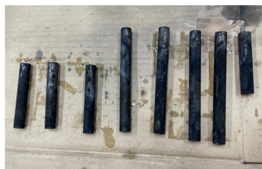
Fig. 2 浸炭焼き入れされた試験片
